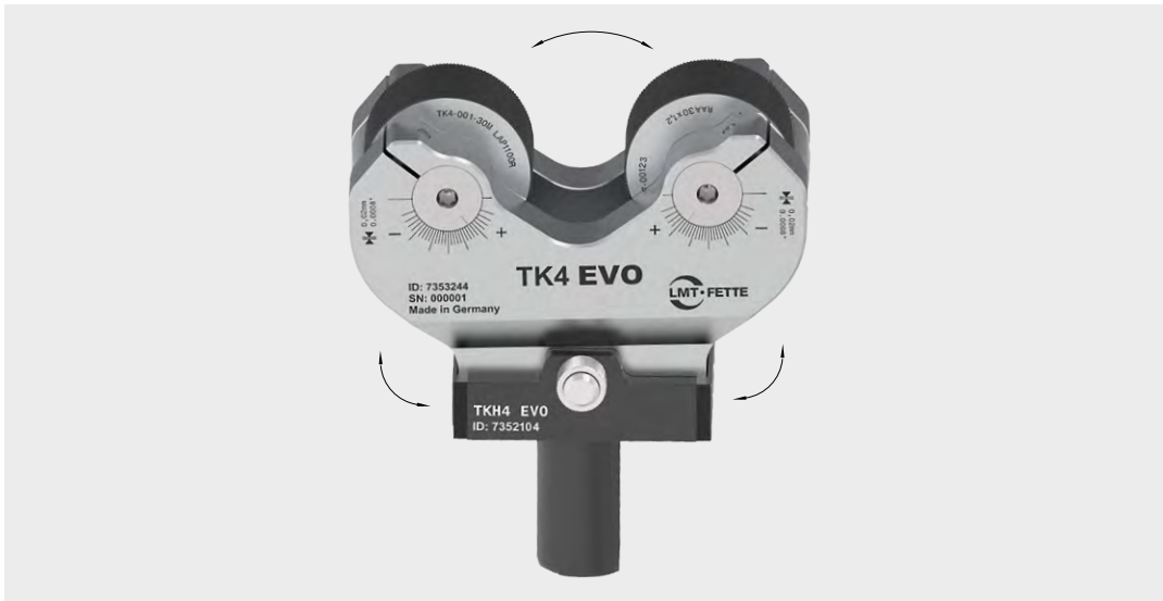
Abb. 14: Überprüfen der pendelnden Lagerung des Rollkopfes im Halter
