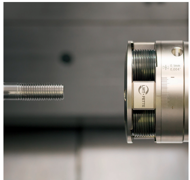
Rollen von Gewinden mit größerer Länge mit Axial-Rollkopf EVOLine Rolling threads with greater length with axial rolling head EVOLine
