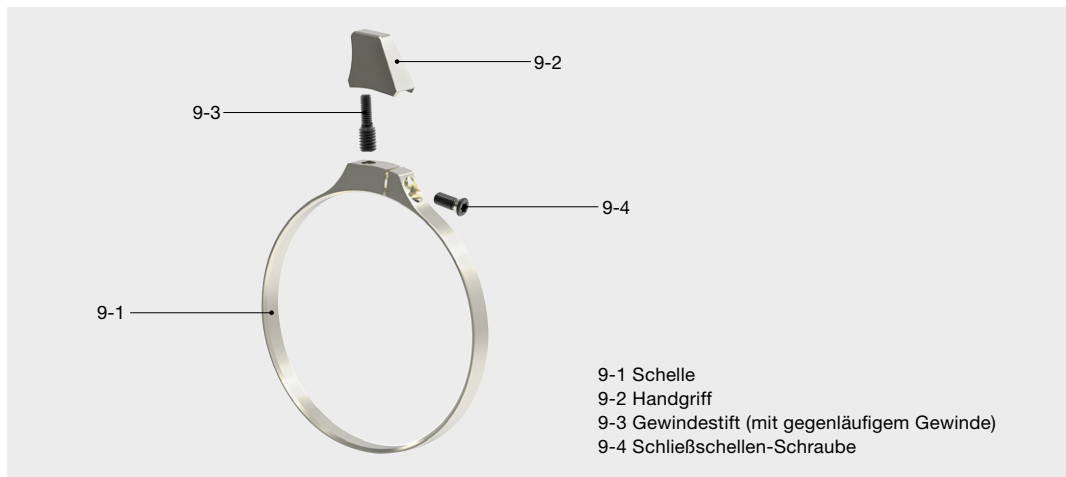
Abb. 8: Schließschelle mit Handgriff
